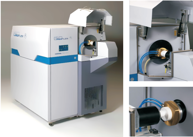
Рисунок 8 (слева). Спектрометр Profiler 2. Рядом: увеличенные фотографии отделения для размещения образцов; виден край образца, прижатого толкателем через охлаждаемый электрод.
