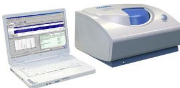
Анализатор SZ-100 предназначен для измерения размеров частиц, дзета-потенциала и молекулярной массы.
